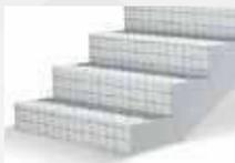
Especial para una escalera liviana de gran resistencia estructural y rápida ejecución, consiste en un bloque de EPS formado acorde con los requisitos de diseño con conductos internos preformados para fundir viguetas de reforzamiento estructural, recubierto con 2 capas de malla en acero galvanizado para ser pañetada y enchapada en obra.
